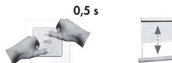
Vérifier le sens de rotation du moteur en appuyant sur Montée ou Descente
