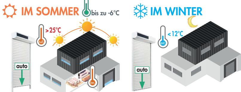
Der Rollladen schließt sich automatisch in die thermische Schutzposition bei starker Sonneneinstrahlung und hohen Innen- oder Außentemperaturen.
