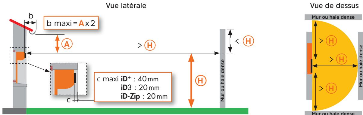
Ⓐ = hauteur du dessus du panneau PV - Ⓜ = hauteur à considérer par rapport au sol et non au plancher
