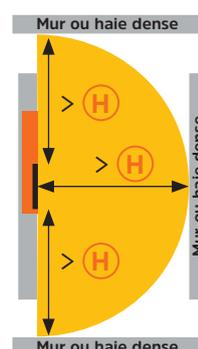
(A) = hauteur du dessus du panneau PV - (H) = hauteur à considérer par rapport au sol et non au plancher
